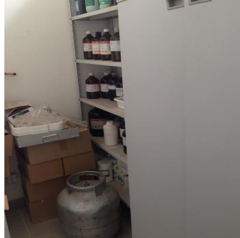
Figura 11: Botijão de G.L.P 13kg dentro do laboratório
