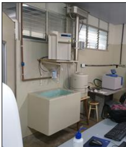
Figura 13: Destilador sem ponto de água.
